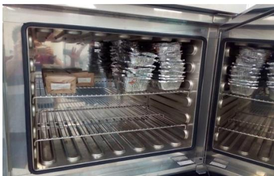
Figura 19: horno de secado de material a 105 grados por 16 horas Fotografía tomada por autor
