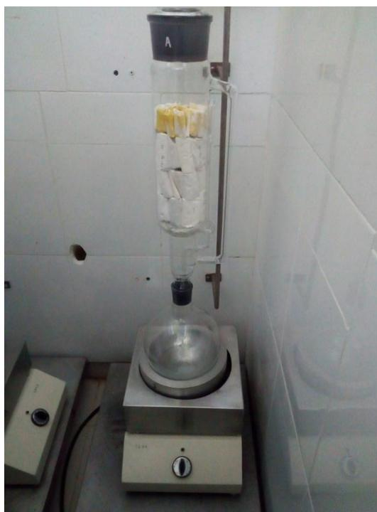
Figura 20: *soxhlet* en proceso de extracción del aceite, Fotografía tomada por autor
