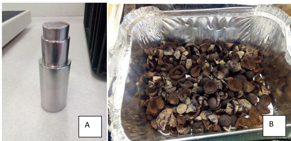
Figura 17 A. macerador para el rompimiento de la nuez, Figura 18 B. división de cuesco y almendra después del macerado
