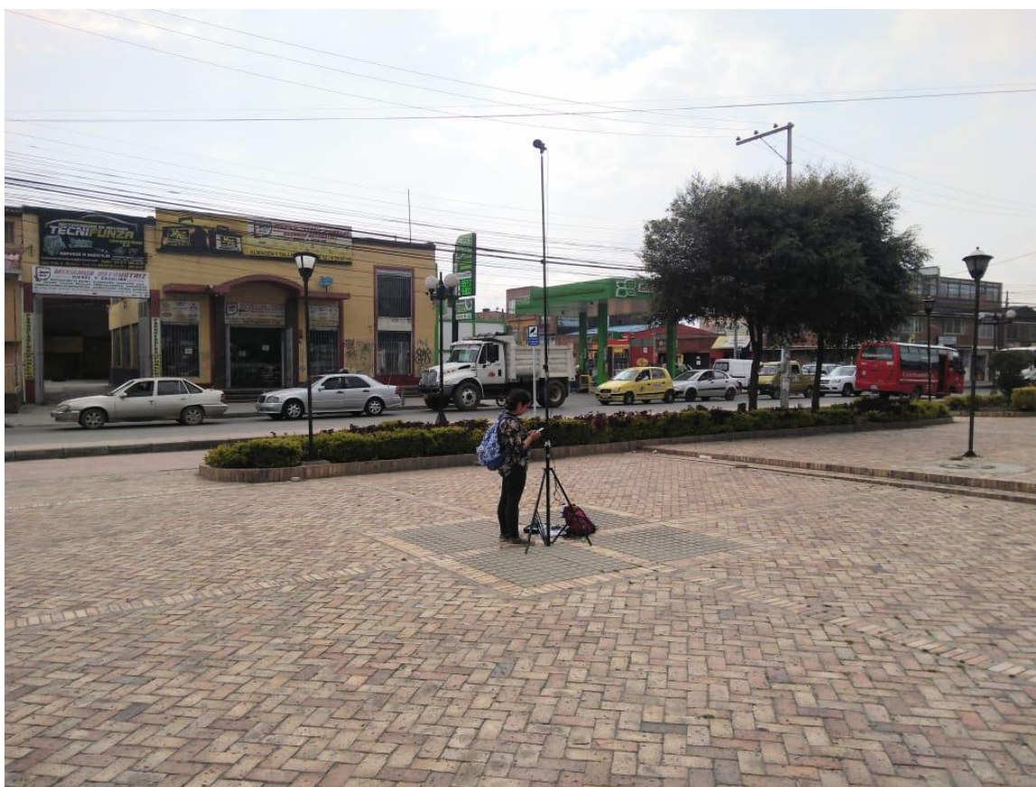
Figura 4. Ubicación del micrófono a una altura de 4 metros.
