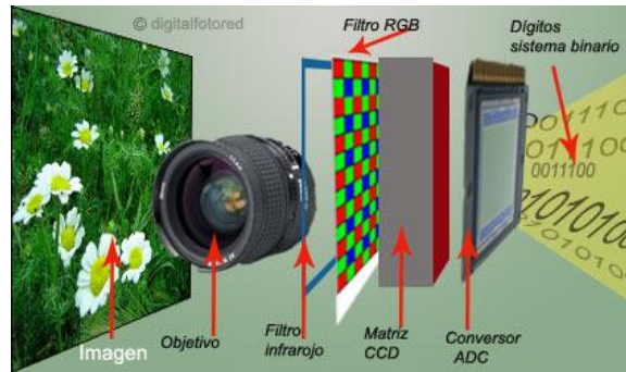
Figura 9. Formación de la imagen digital
