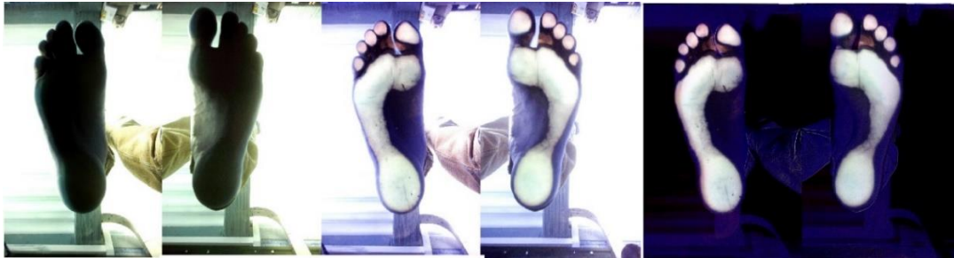
Figura 43. Eliminación de iluminación externa
