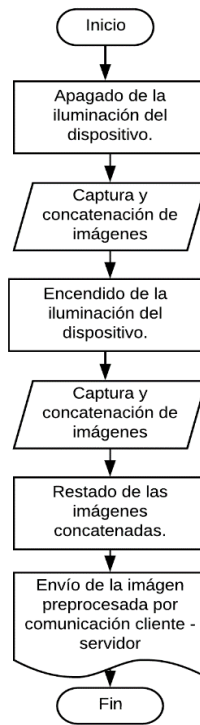
Figura 44. Diagrama de flujo eliminación de fuentes de iluminación externas
