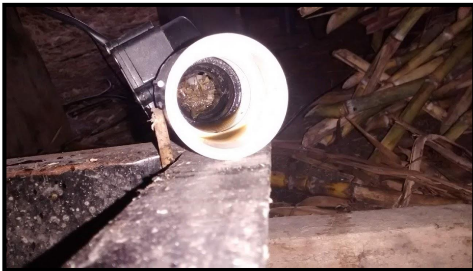
Imagen 62. Evidencia de taponamiento de sensor de flujo.
