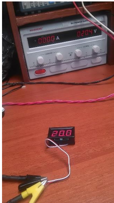
Ilustración 10. Prueba de calidad a voltímetro 7 seg rojo. Elaborada por el autor.
