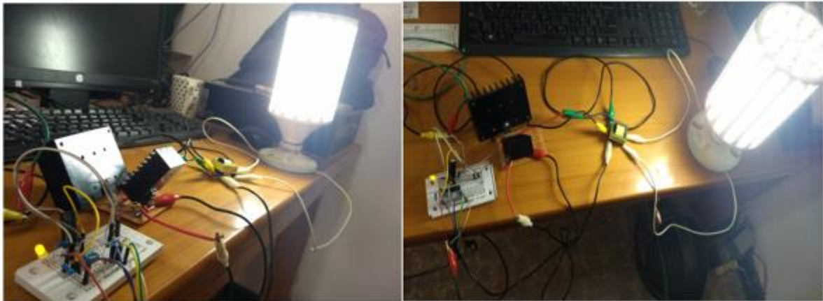
Ilustración 21. Pruebas de laboratorio inversor DC/AC. Elaborada por el autor.
