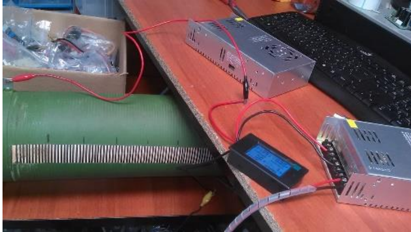
Ilustración 9. Prueba de calidad a medidor digital multifuncional DC PZEMO. Elaborada por el autor.
