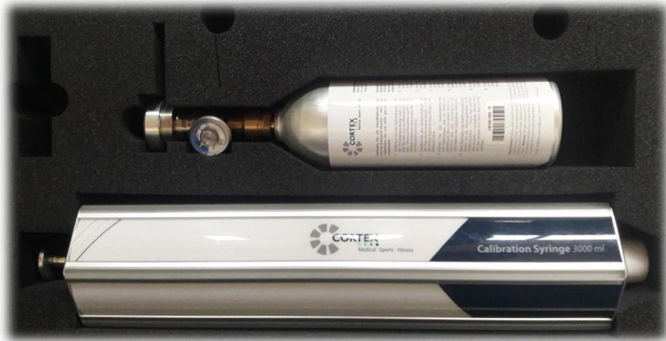
Imagen 11. Material de calibración para el espirómetro.
