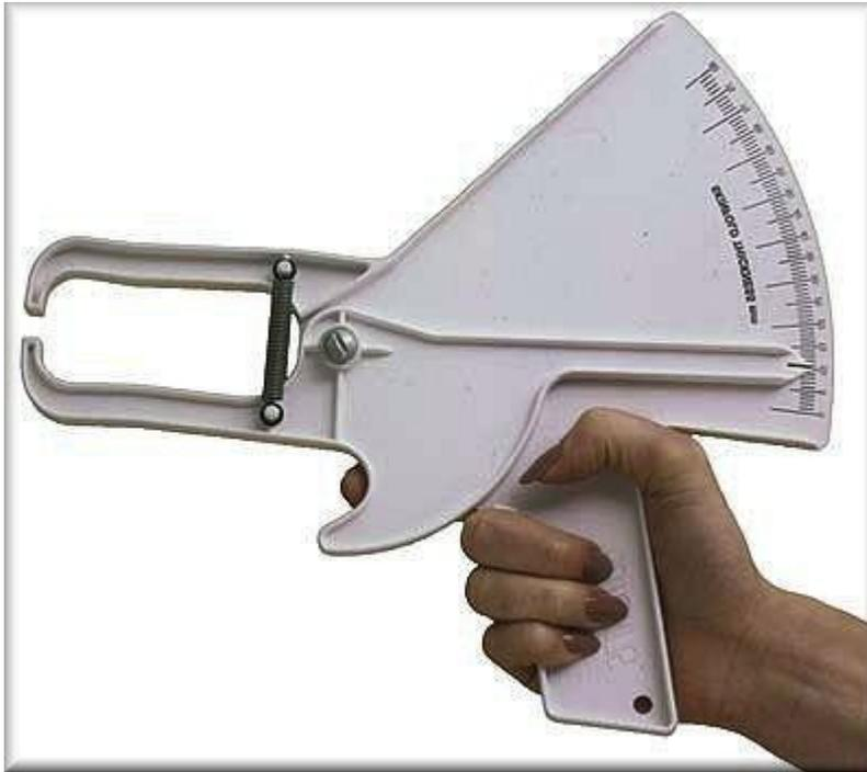
Figura 2. Adipometro caliper. (Medidor de pliegues)
