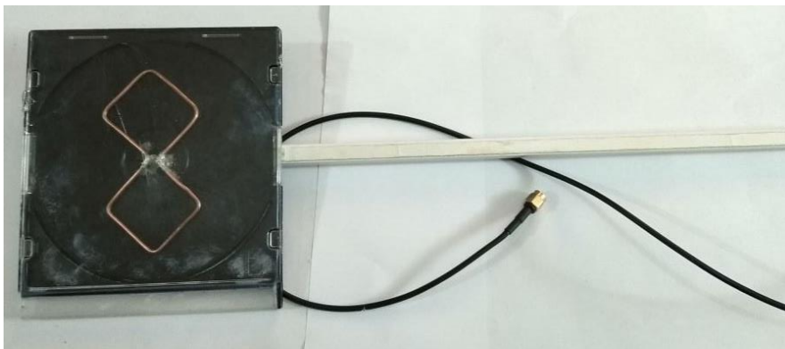
FIGURA 26. ANTENA BI-QUAD CONSTRUIDA.
