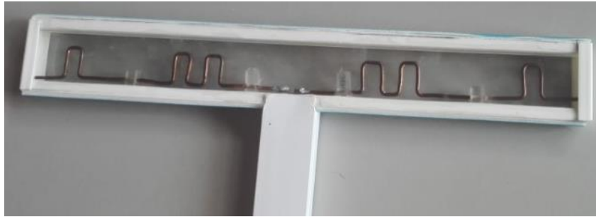
FIGURA 30. ANTENA FRANKLIN CONSTRUIDA.
