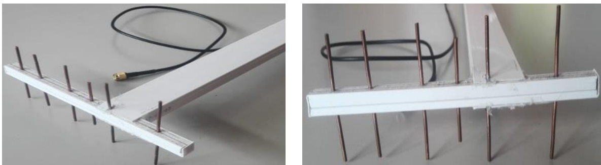
FIGURA 22. ANTENA YAGI-UDA CONSTRUIDA.
