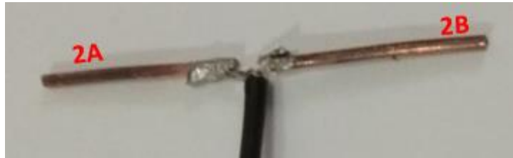
FIGURA 20. SOLDADURA DIPOLO ANTENA YAGI-UDA
