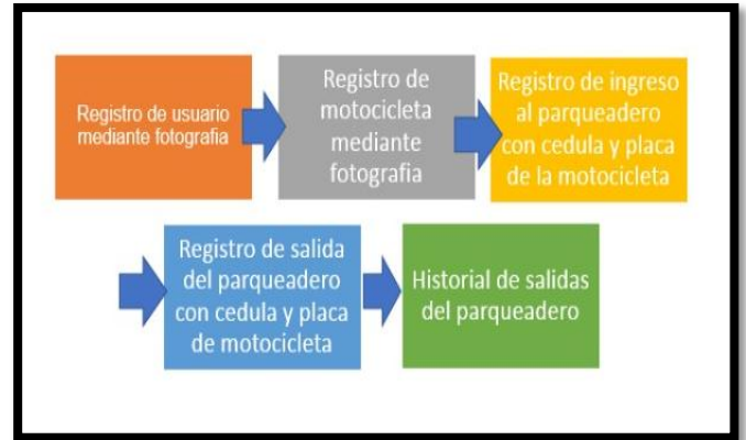
Fig. 1. Diagrama base representando el ciclo que cumplirá la información a través del sistema
