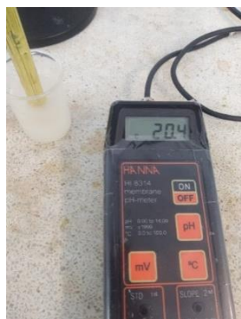
Figura 49. Lectura de pH de bebida tipo sake a 20°C.
