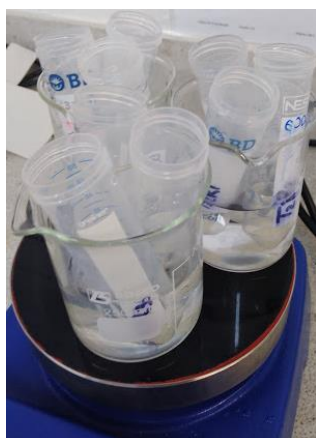
Figura 34. Sustrato en solución NaCl (1%) a 28°C en plancha de agitación.
