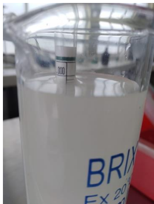
Figura 46. Lectura de densidad con aerómetro.
