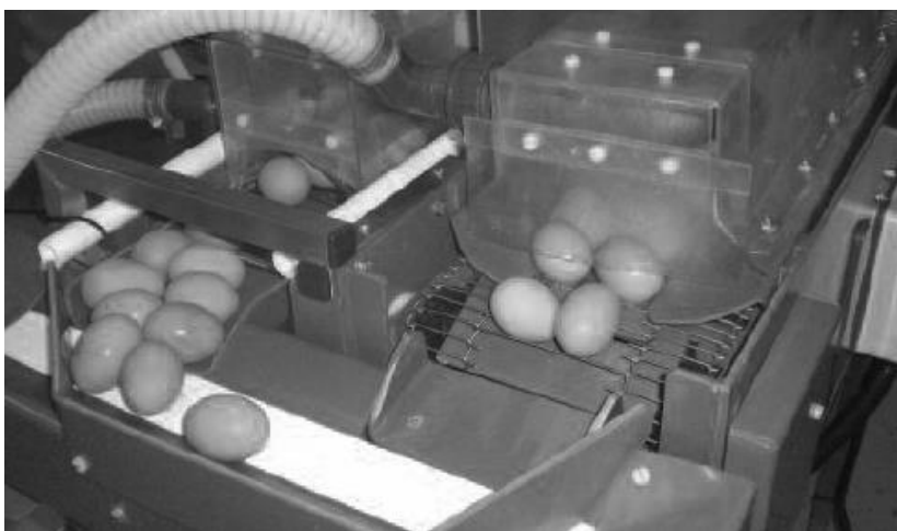
Figura 4. Maquinas limpiadoras de huevos comerciales (1400 huevos / hora).
