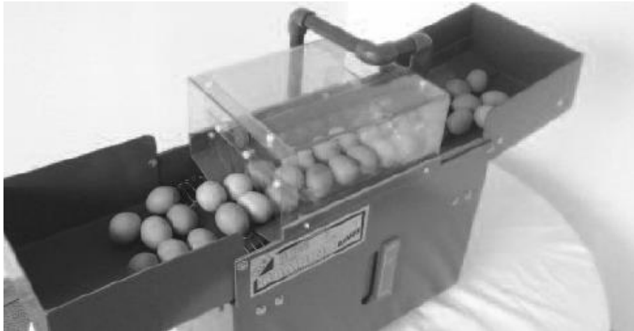
Figura 5. Maquinas limpiadoras de huevos comerciales (800 huevos / hora).
