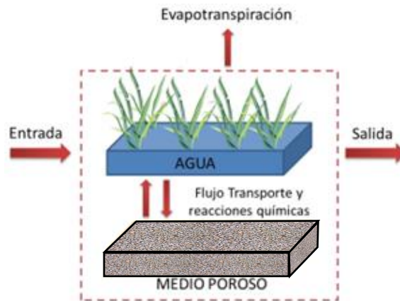
Ilustración 22 Modelo conceptual de un humedal artificial
