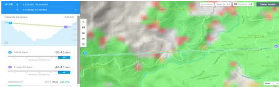
Figura N° 19: Enlace PTP San José y Comunidad Don Ángel (I y II), Ganancia entre TX y RX, Altura de Antenas y Capacidad de la Transmisión (Autor).
