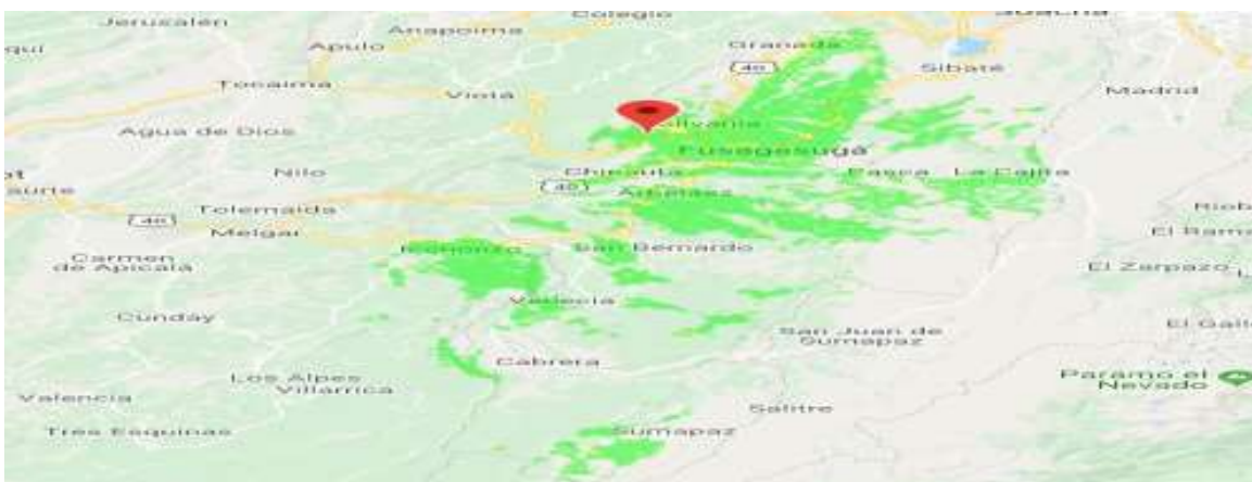
Figura N° 4: Cobertura antena San José (Verde > señal), software Radio Mobile (Autor).
