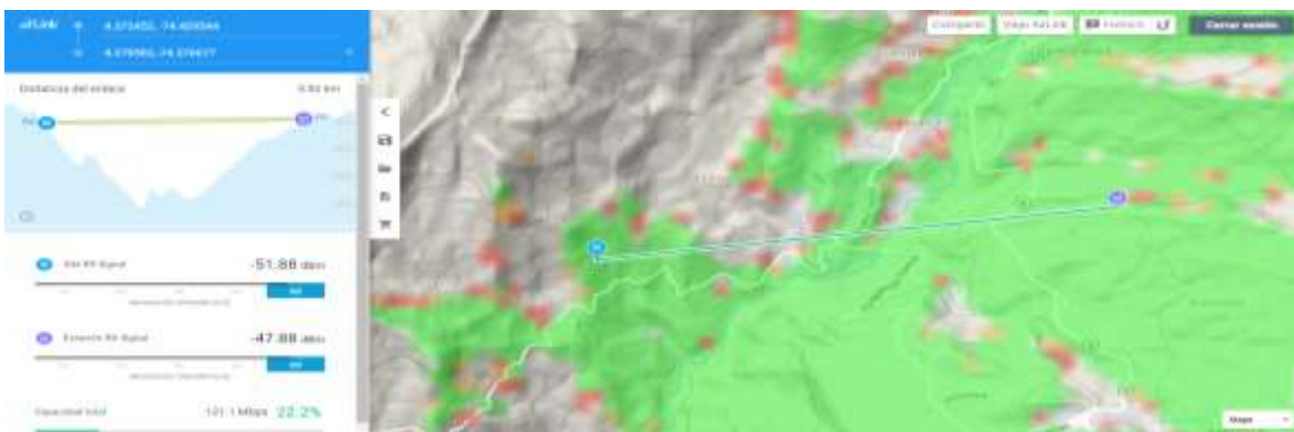
Figura N° 21: Enlace PTP San José (Sectorial) y Comunidad Don Mario, Ganancia entre TX y RX, Altura de Antenas y Capacidad de la Transmisión (Autor).
