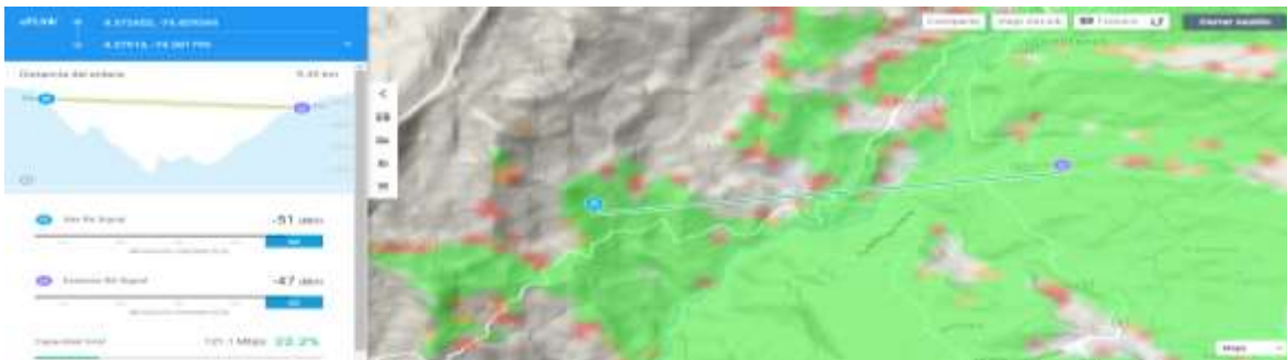
Figura N° 23: Enlace PTP San José (Sectorial) y Comunidad Don Mario, Ganancia entre TX y RX, Altura de Antenas y Capacidad de la Transmisión (Autor).
