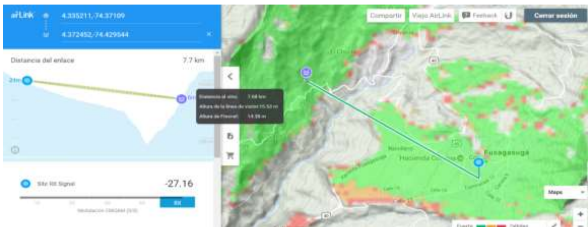
Figura N° 8: Señal AP, Distancia, Altura de visión y Altura de Fresnel; software AirLink (Autor).
