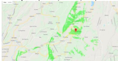
Figura N° 2: Cobertura antena Bloque F (Verde = señal), software Radio Mobile (Autor).
