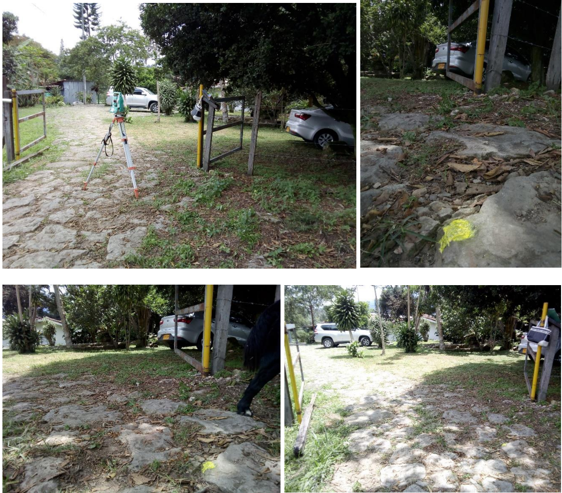
Fotografía 12 Ubicación de punto base para las distancias y ángulos a los otros puntos.
