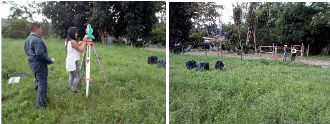
Fotografía 9 Toma de Puntos de la División.
