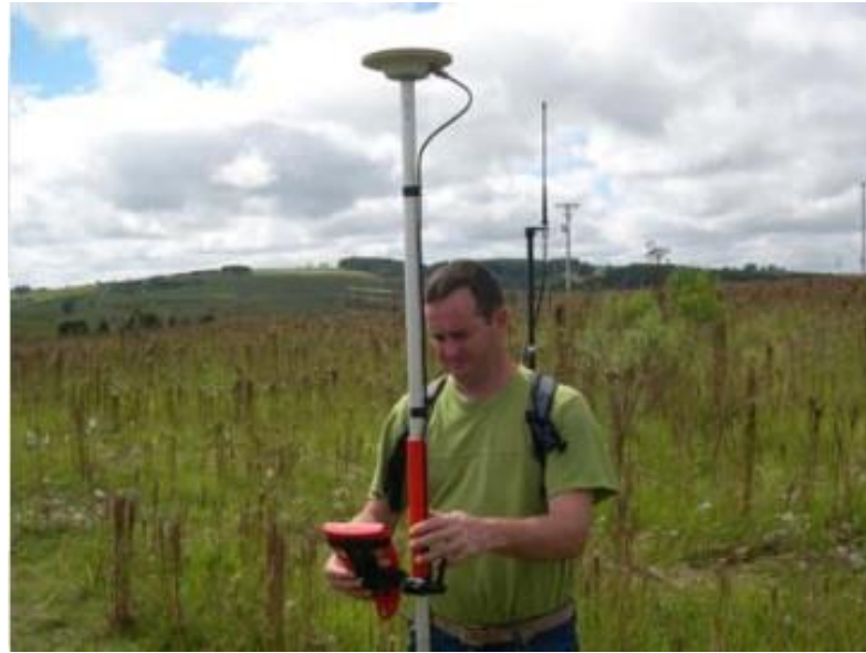
Imagen 5 Levantamiento GPS RTK
