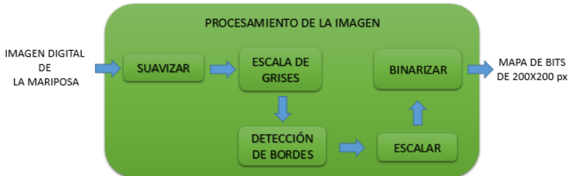
Figura 29. Diagrama detallado para el procesamiento de las imágenes.
