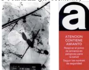
Figura A1.11 Fibras de amianto en aire recogidas en filtro para recuento (Microscopía electrónica 2000X)
