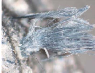
Figura A1.4 Material con amianto CROCIDOLITA (60 X)
