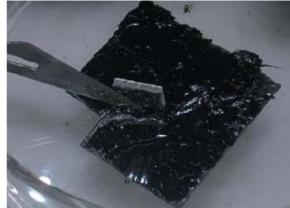
Figura A1.9 Material NO FRIABLE (tela asfáltica)
