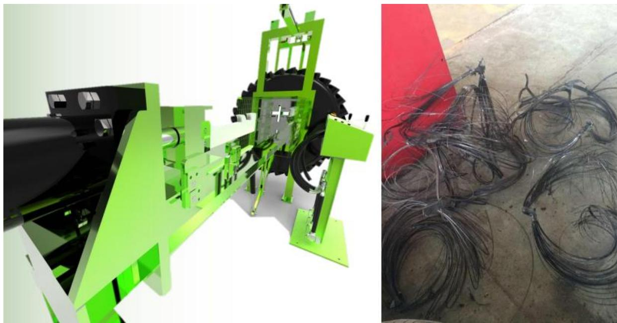
*Figura 31.* Maquina Destalonadora Y Destalonado
