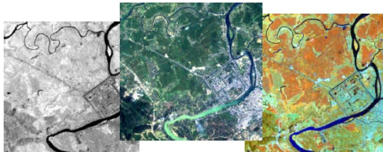
Ilustración 3. Resolución Espectral. Derecha: Imagen con una sola banda. Centro e izquierda: Combinación de tres bandas 3,2,1 y 4,5,3.
