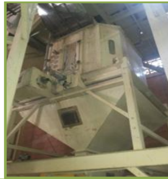
Luego de ser peletizado es pasado al enfriador para poder ser quebrantado
