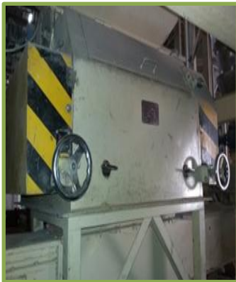
Luego de ser enfriado se hace la descarga con cierta frecuencia y se ajusta el quebrantador para adecuar el tamaño deseado del pellet
