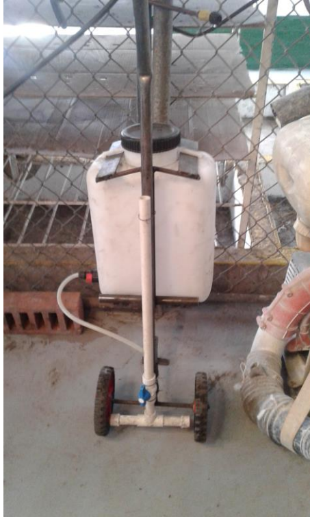
Ilustración 2. Bomba para aplicación de herbicidas construida en forma artesanal construido en Plazoleta Bazzani S.A.S por Ricardo Guayambuco (Supervisor de mantenimiento) y José Ordoñez (Supervisor de fumigación) (Angel, 2017)
