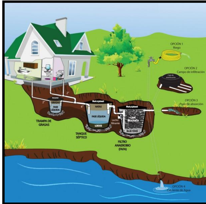
Imagen 4. Unidades básicas de una fosa séptica
