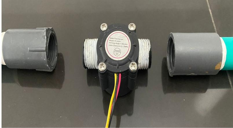
Figura 44. Conexión del sensor. Elaboración propia.
