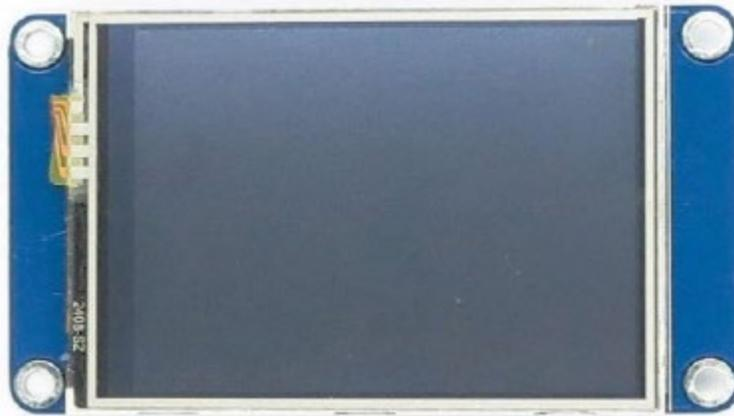
Figura 14. Módulo de visualización TFT. Elaboración propia.
