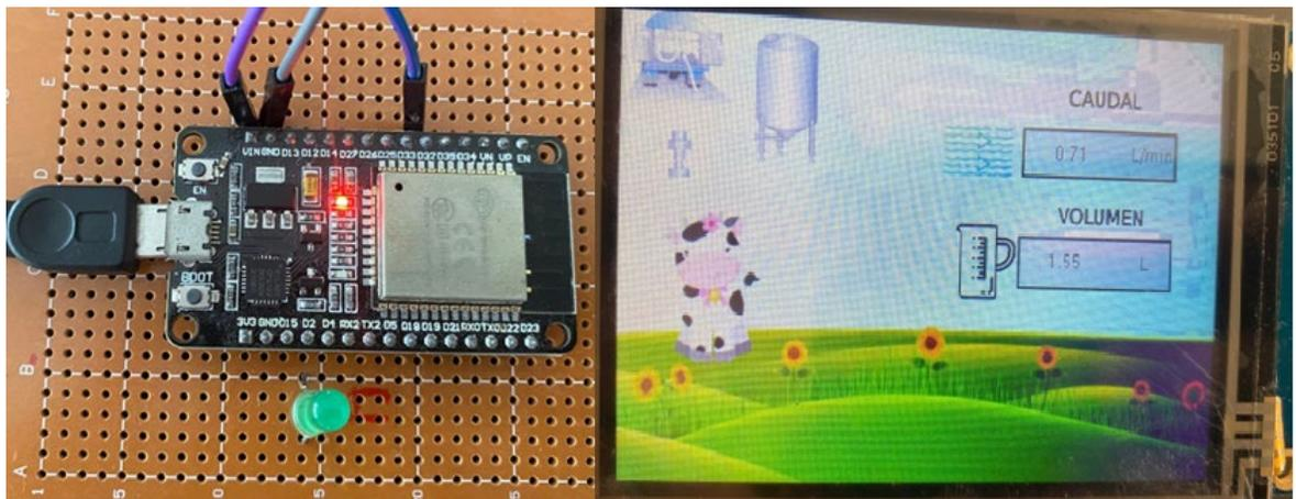
Figura 47. Conexión Microcontrolador, Pantalla Nextion. Elaboración propia.
