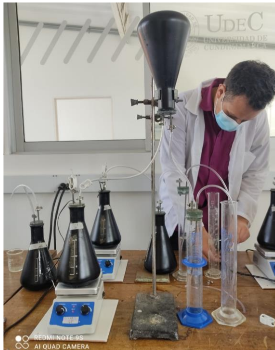
Figura 20. Sistema implementado para medición de biogás
