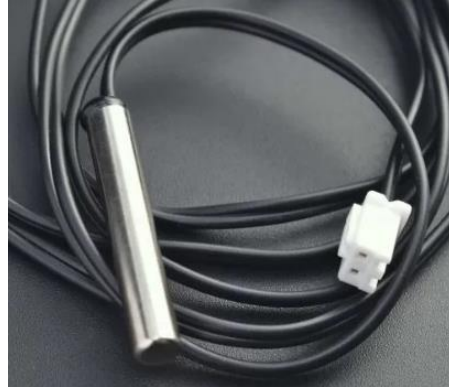
Figura 18. Termistor NTC 10 kΩ a utilizar en el experimento
