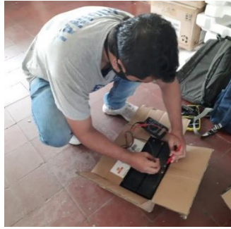
Fig. 90. Medición del voltaje de las baterías.
