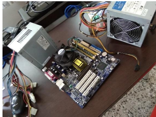
Fig. 45. Verificación del funcionamiento individual de las motherboard con una fuente de poder.
