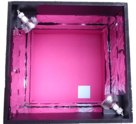
Figura 4.27: Diseño físico del interior de la caja oscura.
