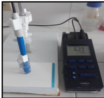
Figura. 26 pH - metro en solución estabilizadora Cloruro de Potasio (KCL), planta Pekín. Martínez (2020).
