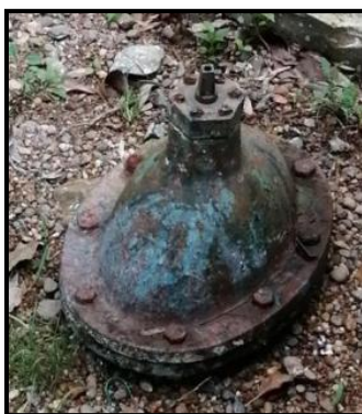
Figura. 15 Accesorios y válvulas hidráulicas con presencia de averías y fugas, planta Pekín. Martínez (2020).
