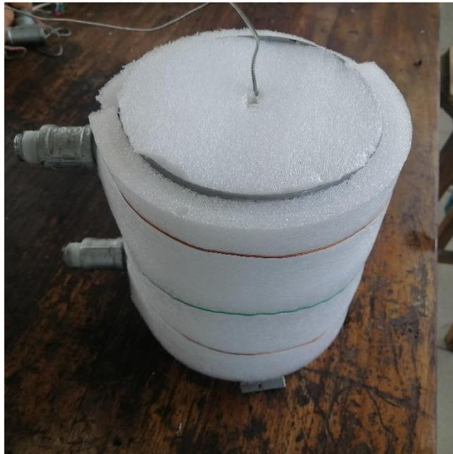
Figura 47. Recipiente de almacenamiento con aislamiento térmico. Elaboración propia.
