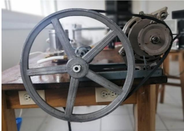
Figura 40. Ensamble de poleas y correa en el motor monofásico y bomba. Elaboración propia.
