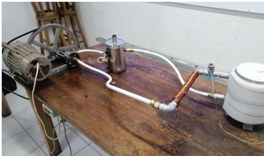
Figura 43. Prototipo de calefacción por inducción para pasteurización. Elaboración propia.
