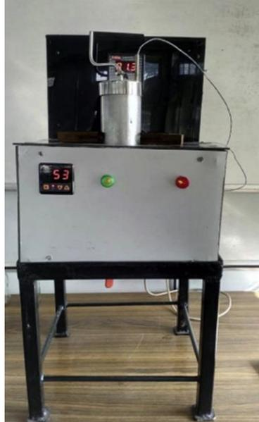
Figura 6. Prototipo del pasteurizador por inducción de 1500 W [15].
