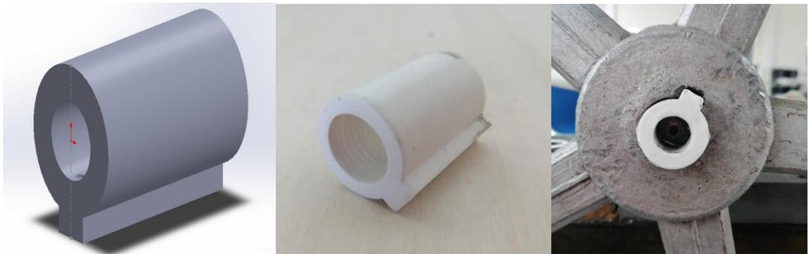
Figura 39. Diseño, impresión y ensamble del acople para la polea conducida. Elaboración propia.
