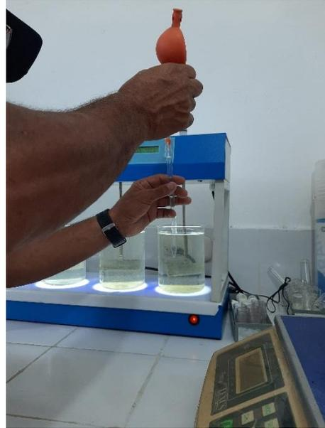
Figura 8. Adición del coagulante.
