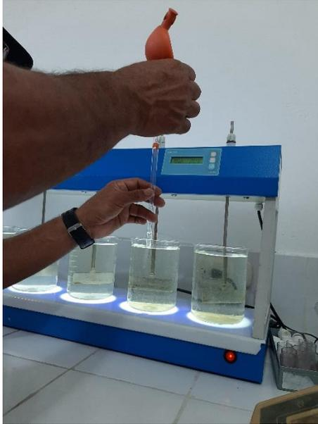
Figura 7. Adición del coagulante.
