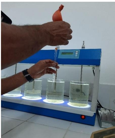
Figura 11. Adición del coagulante.
