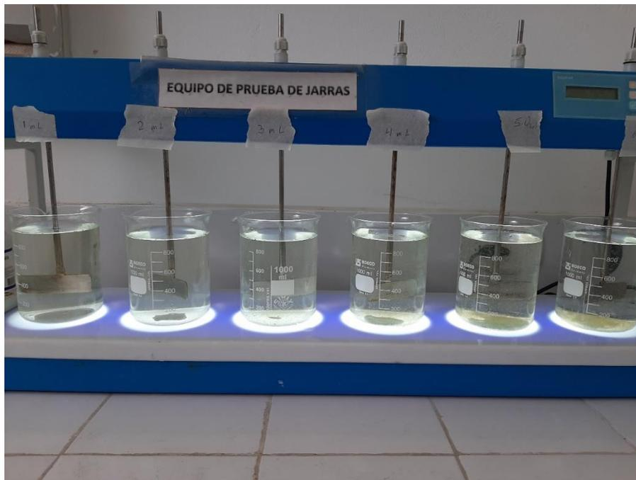
Figura 9. Primer test de jarras. 1, 2, 3, 4, 5 y 6ml de Coagulante AK 10-346 al 1%.
