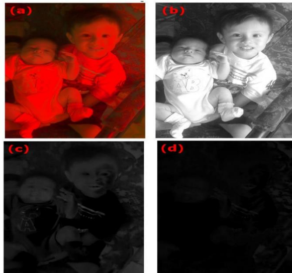
Figura 27. Espacio de color YIQ y sus respectivos componentes. a-Formato YIQ, b-Luminancia (Y), c-Crominancia(I), d-Crominancia(Q)
