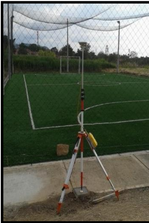
Imagen 11 Antena receptora sobre el mojón GPS1.
