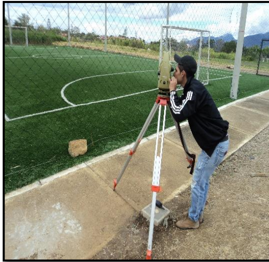
Fotografía . Observación desde GPS 1 a lindero y vista desde delta 03 hacia paramento de construcción.
