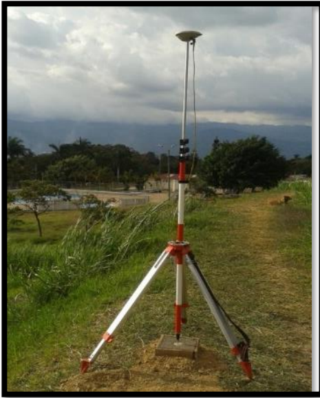
Imagen 11 Antena receptora sobre el mojón GPS1.
