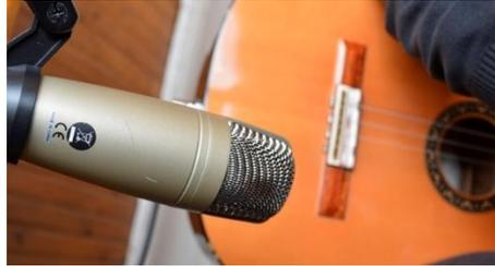
Luego de tener el set de micrófonos puestos en su lugar, procederemos a conectarlos a la interfaz de audio (Convertidor A/D), dos de los instrumentos acústicos (Tiple colombiano y Bandola andina) tienen incorporado un preamplificador, el cual permitió mandar otra señal de audio adicional, esta señal es enviada a través un cable TS (cable línea). Para la guitarra acústica no fue posible esta conexión ya que no contaba con preamplificador. La conexión en la interfaz fue la siguiente.
