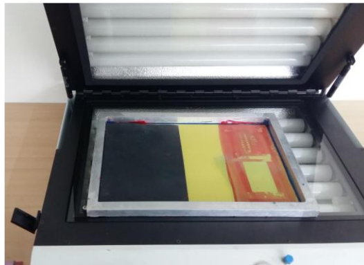
Figura 17. Protección del bastidor con una cartulina negra.
