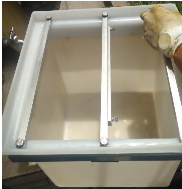
Figura 7. Tanque de galvanoplastia limpio.
