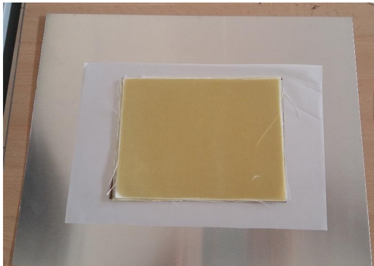
Figura 36. Láminas aluminio, tedlar, cobre y prepreg.
