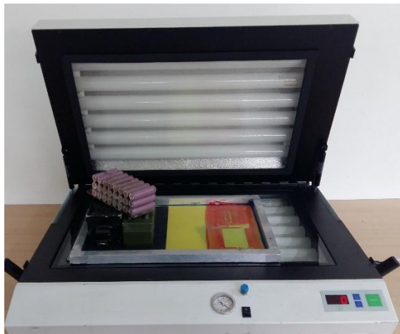
Figura 18. Peso sobre la tela del bastidor.
