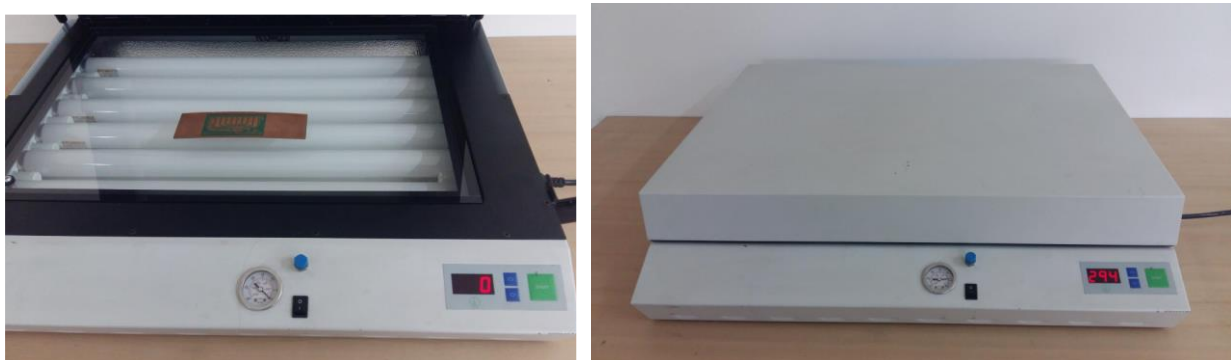
Figura 31. Secado de la tinta UV en la insoladora.
