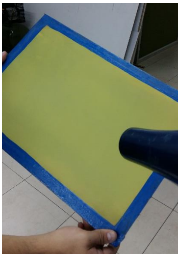
Figura 57. Secado de la tela del bastidor.
