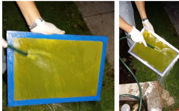
Figura 56. Aplique de agua sobre el bastidor.
