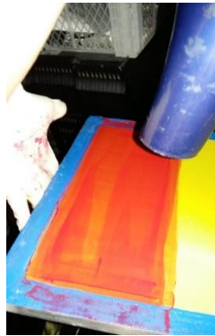
Figura 14. Secar la mezcla en la tela del bastidor.
