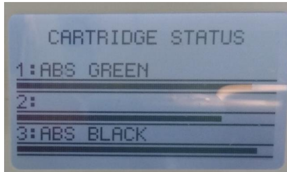
Figura 25. Prueba de reconocimiento de los cartuchos instalados.
