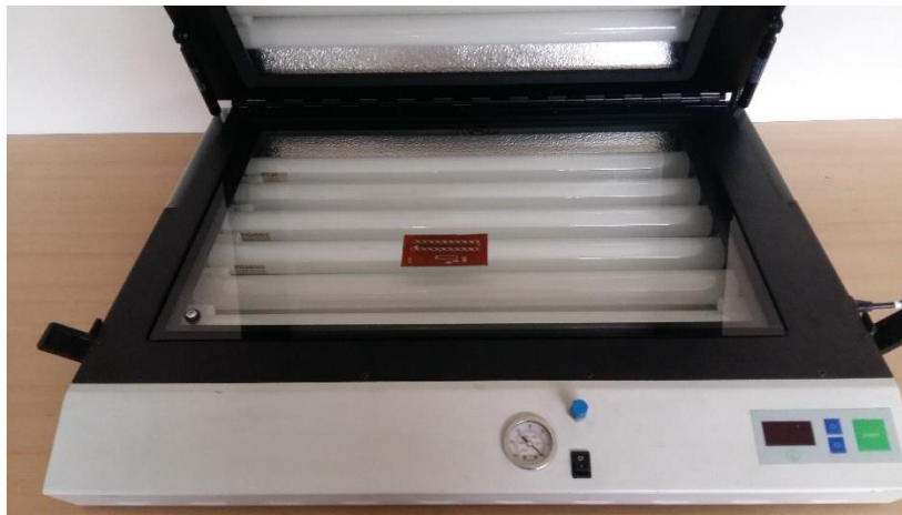
Figura 50. Secado de la tinta UV en la insoladora.
