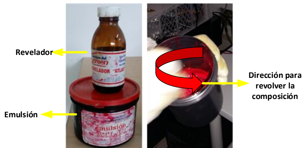
Figura 10. Composición homogénea fotosensible.
