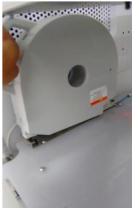
Figura 29. Sacando el cartucho de la impresora 3D.
