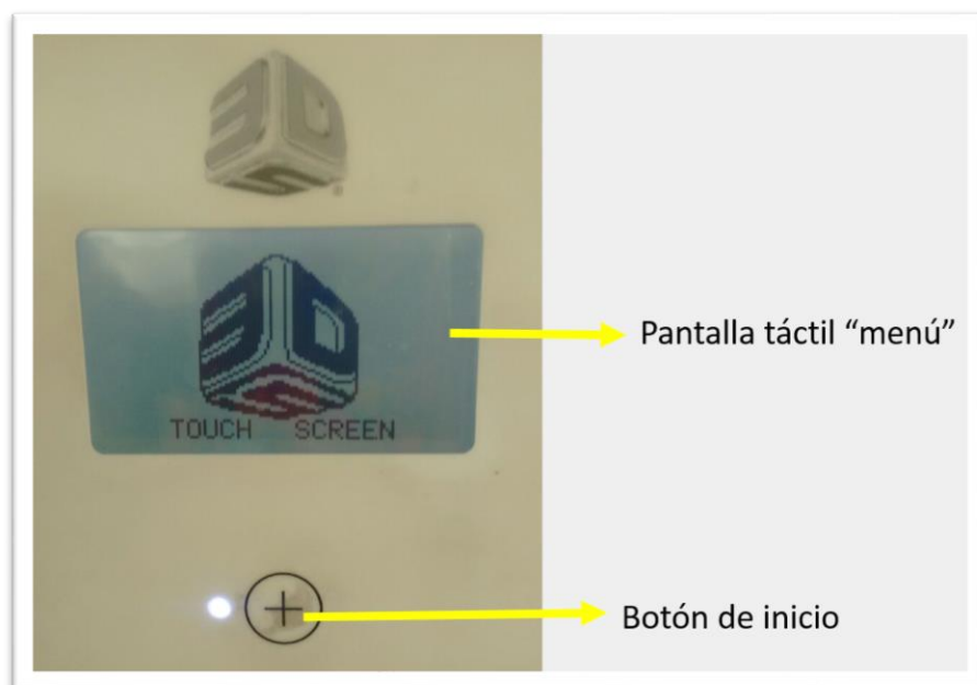
Figura 17. Descripción del menú de la impresora 3D.
