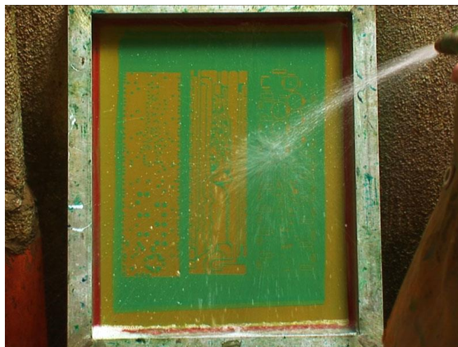
Figura 10. Revelado de la imagen en la tela.
