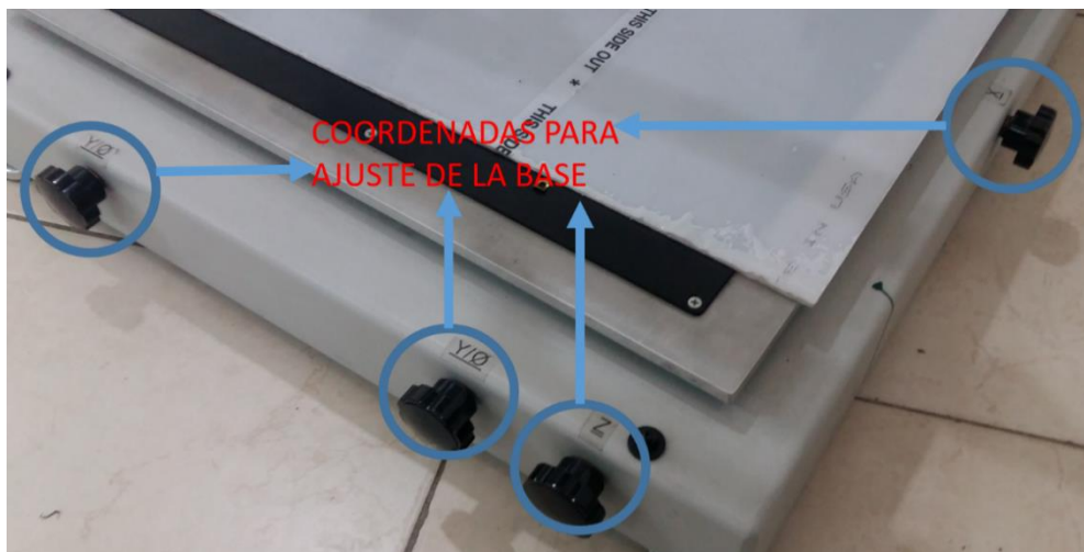
Figura 5. Perillas de ajuste para la máquina Stencil Print.
