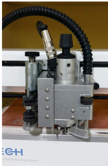
Figura 60. Máquina ubicada en la posición para el cambio de herramienta (Tool Change).
