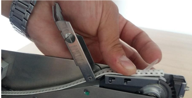
Figura 26. Posición correcta de la tira de componentes.
