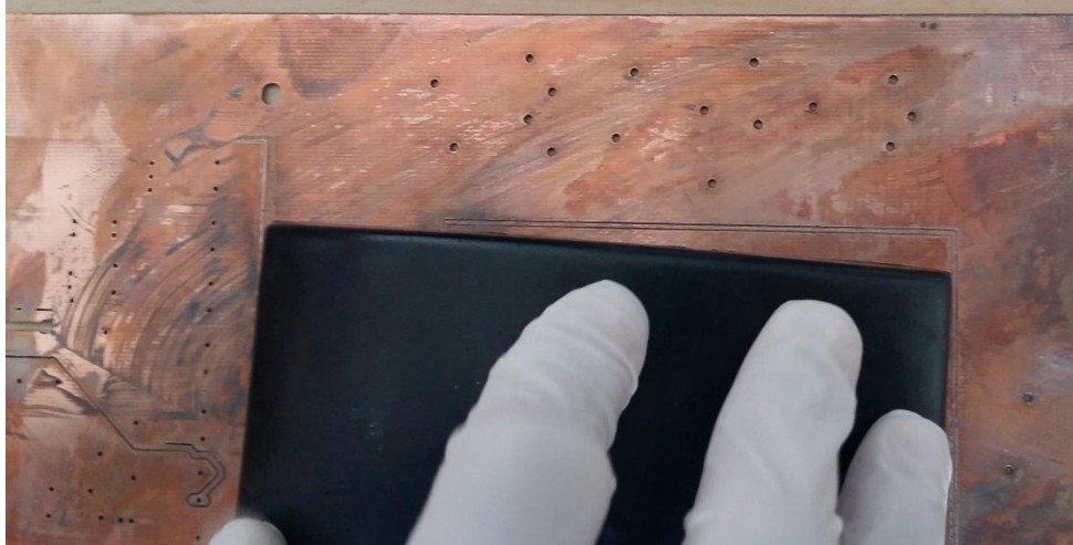
Figura 15. Limpieza de la Baquelita con bloque de lija plana.
