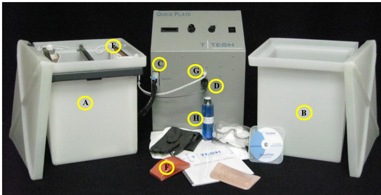
Figura 2. Componentes del sistema Quick Plate. (T-TECH, Inc., 2001)
