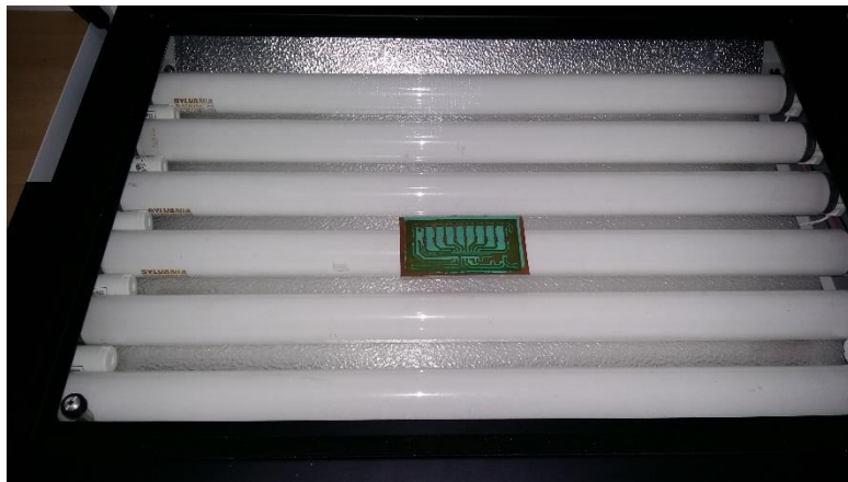
Figura 44. Secado de la tinta UV en la insoladora.
