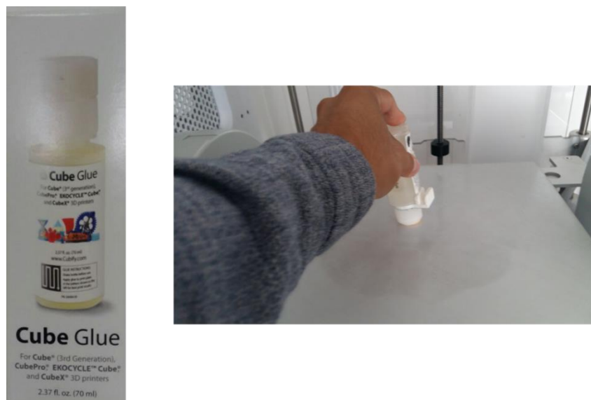
Figura 69. Pegante CubexGlue y forma de aplicación.
