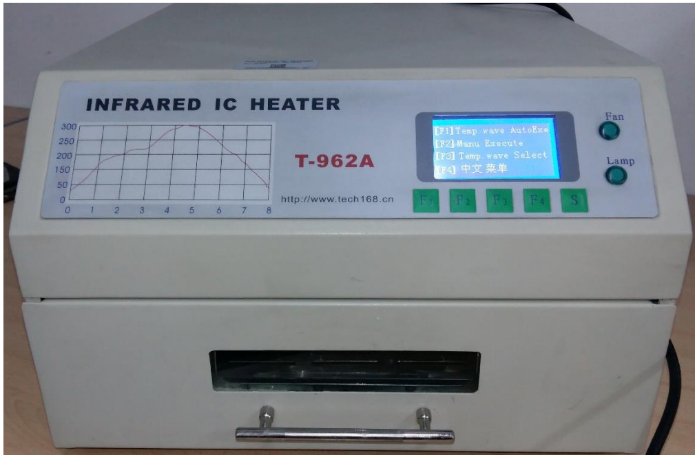
Figura 49. Horno infrarrojo T962-A.
