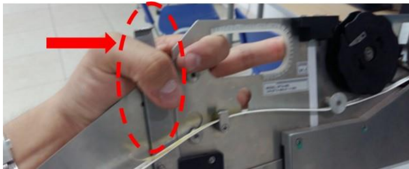
Figura 29. Palanca de acoplamiento y seguro del brazo.
