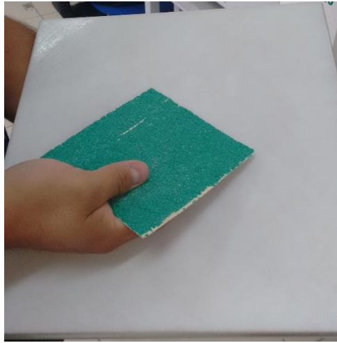
Figura 40. Plataforma de impresión y lija para la rugosidad.
