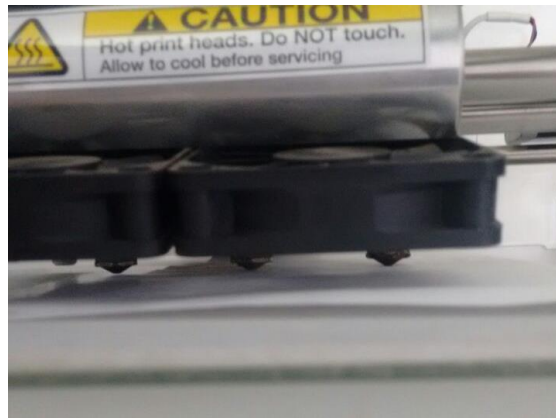
Figura 45. Posición de los cabezales con la plataforma de impresión.
