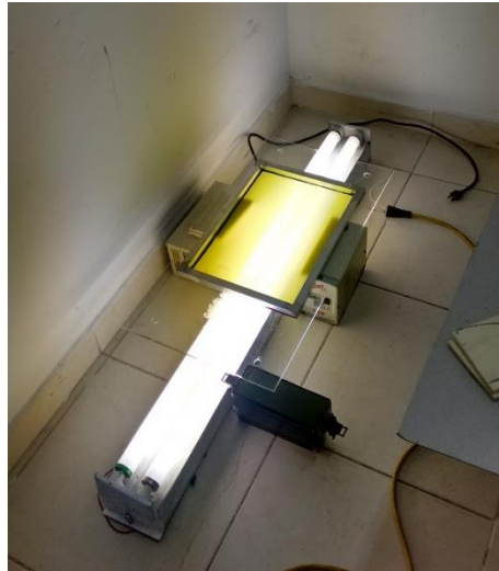
Figura 86. Insoladora creada con recursos del centro de investigación.
