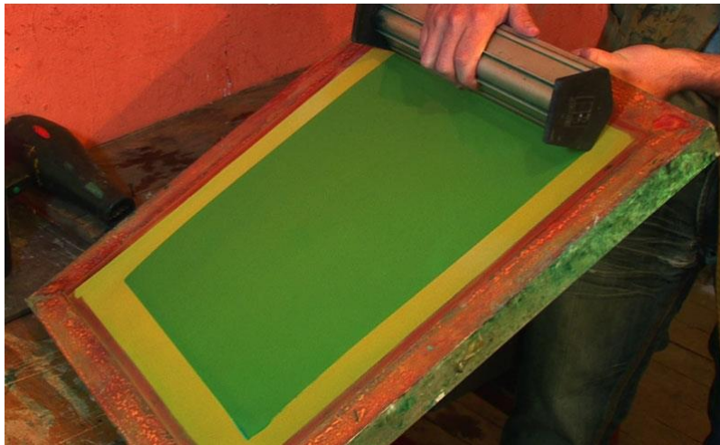
Figura 8. Sensibilización de la tela del bastidor.
