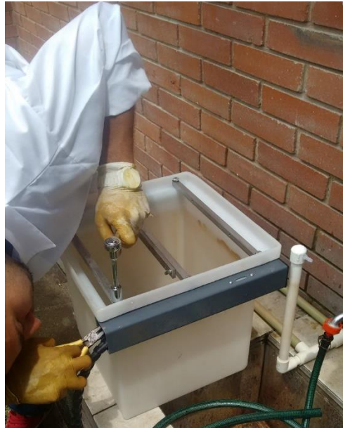
Figura 52. Desarmando el tanque de la quick plate.
