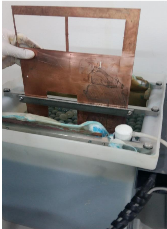
Figura 17. Baquela en el tanque de galvanoplastia.
