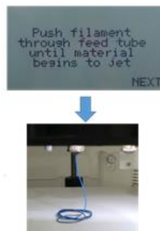
Figura 36. Presione filamento por el tubo de alimentación hasta que comience el material a salir.
