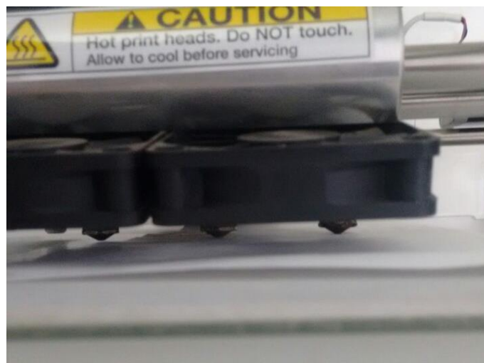
Figura 30. Posición de los cabezales con la plataforma de impresión.
