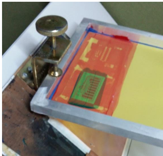
Figura 41. Impresión en falso de la tinta UV.
