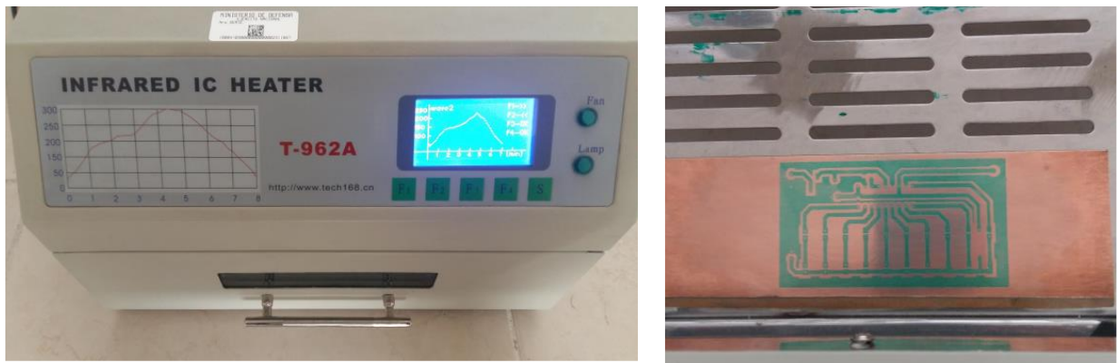
Figura 30. Secado de la tinta UV en el horno.
