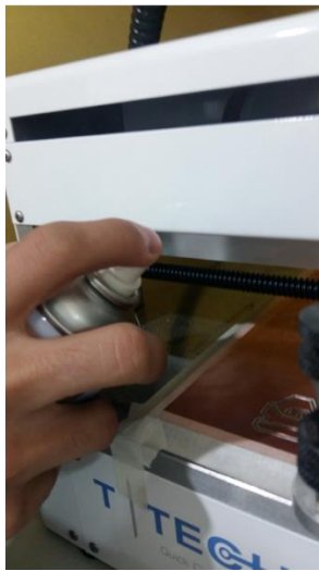
Figura 35. Lubricación de los ejes X y Y.
