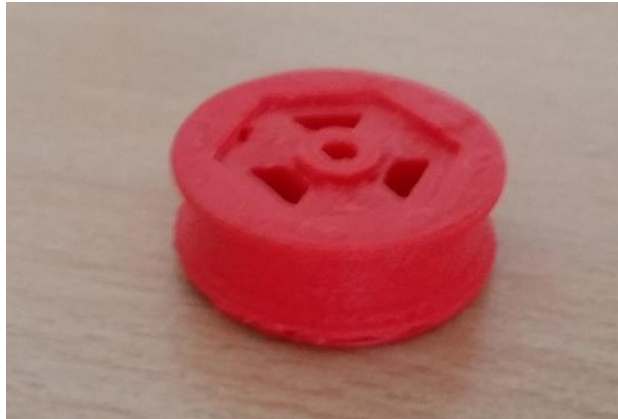
Figura 36. Impresión del rin de una llanta diseñado en Cubify Invent
