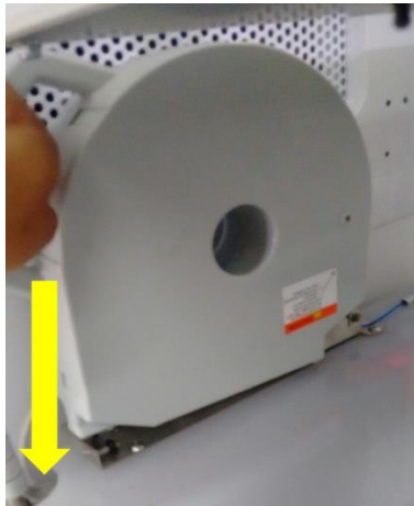
Figura 35. Ajuste del cartucho de impresión.
