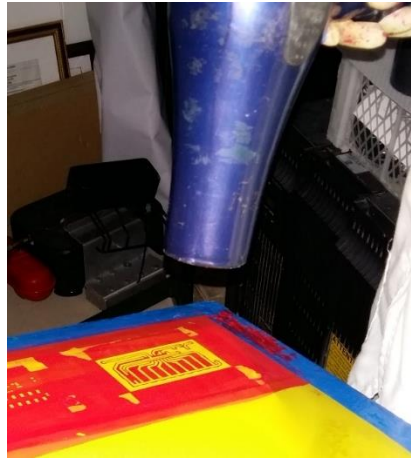
Figura 22. Secar el bastidor.
