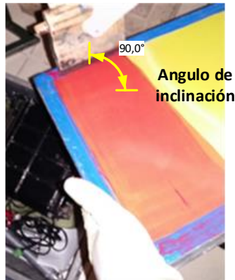
Figura 13. Recoger la mezcla sobrante en la tela del bastidor.
