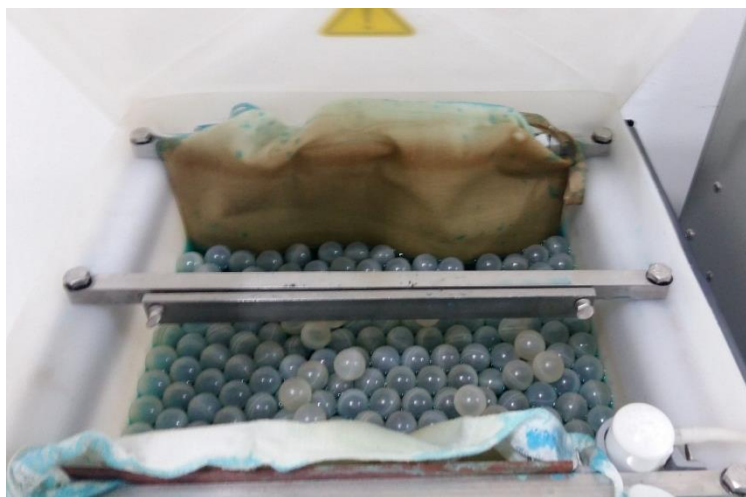
Figura 6. Tanque de galvanoplastia sin tapa.
