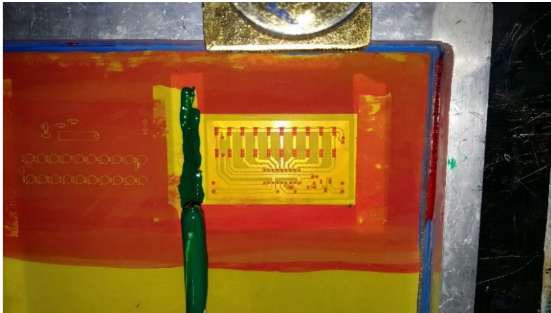
Figura 40. Aplicación de la tinta UV.
