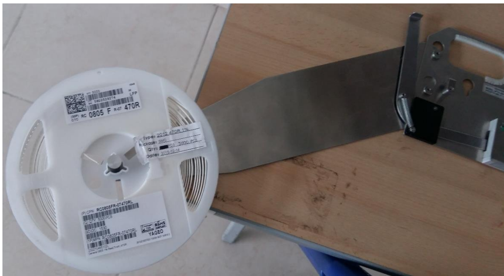
Figura 23. Rollo de componentes en el soporte.
