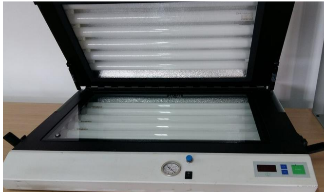
Figura 1. Máquina Insoladora AZ220.
