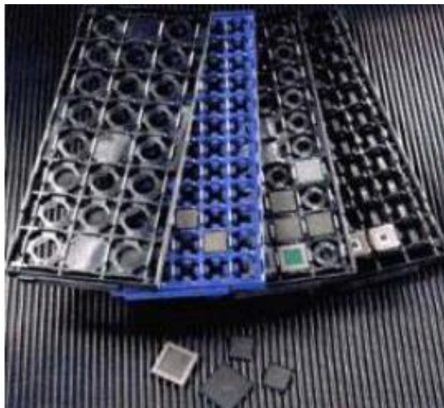
Figura 15. Varillas que contienen a los SMD.
