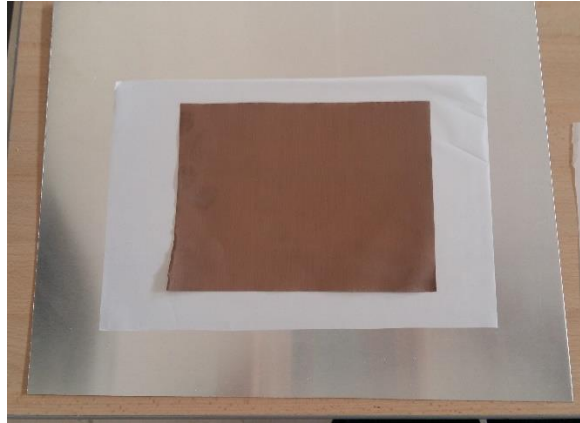
Figura 35. Láminas aluminio, tedlar y cobre.
