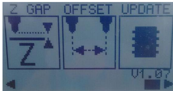
Figura 44. Menú principal con opciones Z-GAP, OFFSET y UPDATE.
