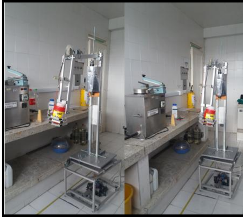
Figura 60. Robot controlado inalámbricamente para la manipulación y traslado de químicos tóxicos y residuos contaminantes.
