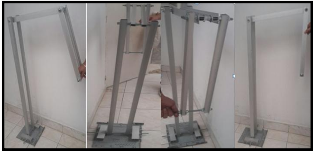
Figura 55. Estructura del brazo robótico terminada mostrando sus articulaciones.
