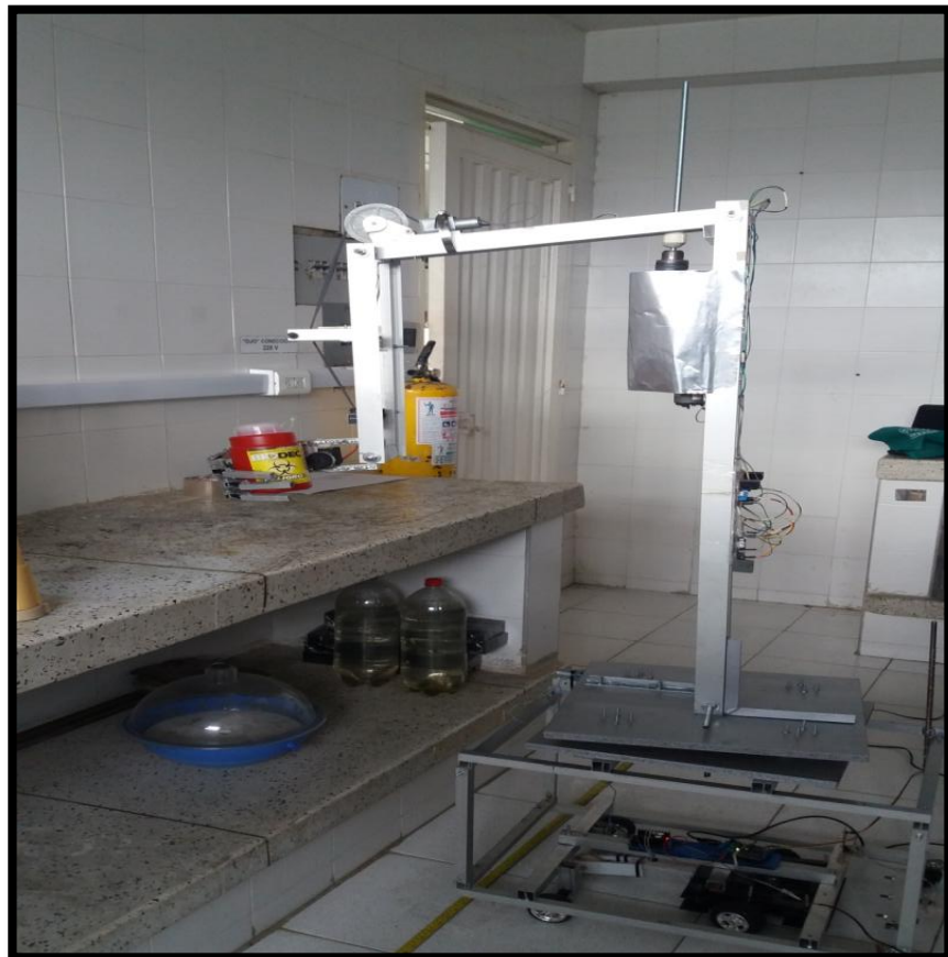
Figura 63. Robot controlado inalámbricamente para la manipulación y traslado de químicos tóxicos y residuos contaminantes con sistema de poleas.
