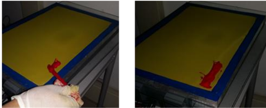
Figura 11. Aplicación a la tela del bastidor de la mezcla fotosensible.
