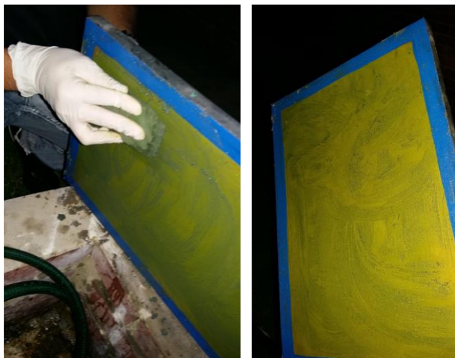
Figura 55. Limpieza de la tela del bastidor.
