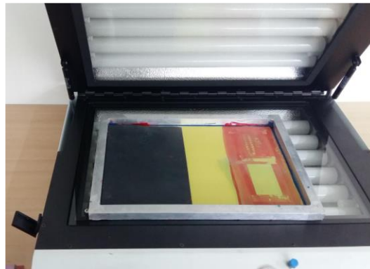
Figura 17. Protección del bastidor con una cartulina negra.
