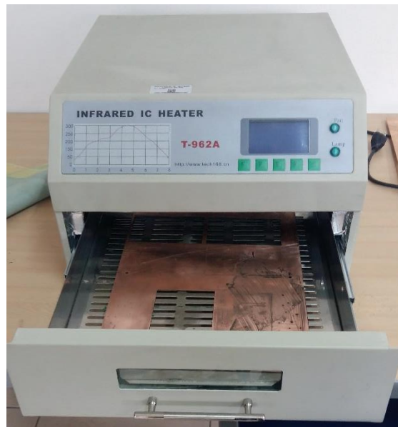
Figura 14. Baqueta en el horno T-962A.
