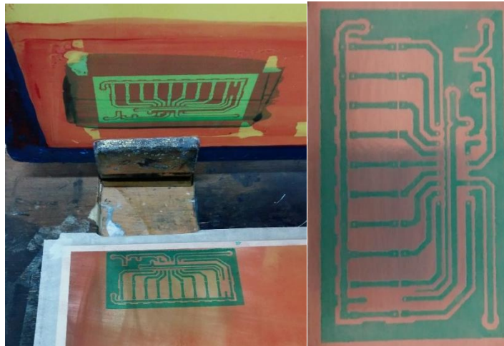
Figura 29. Circuito impreso en la baquelita.
