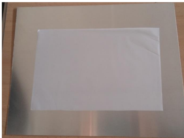
Figura 34. Láminas aluminio y tedlar.
