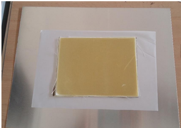
Figura 36. Láminas aluminio, tedlar, cobre y prepreg.
