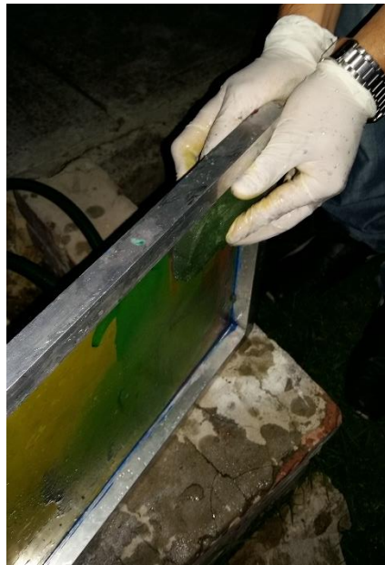
Figura 54. Limpie ambas caras del bastidor.
