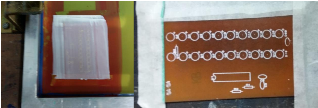
Figura 49. Componentes impresos en la baqueta.
