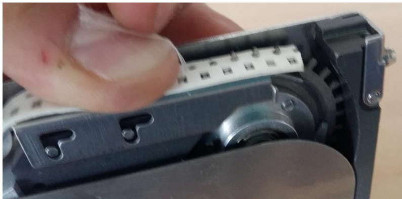
Figura 27. Introduzca los huecos de la tira en el piñón del brazo.
