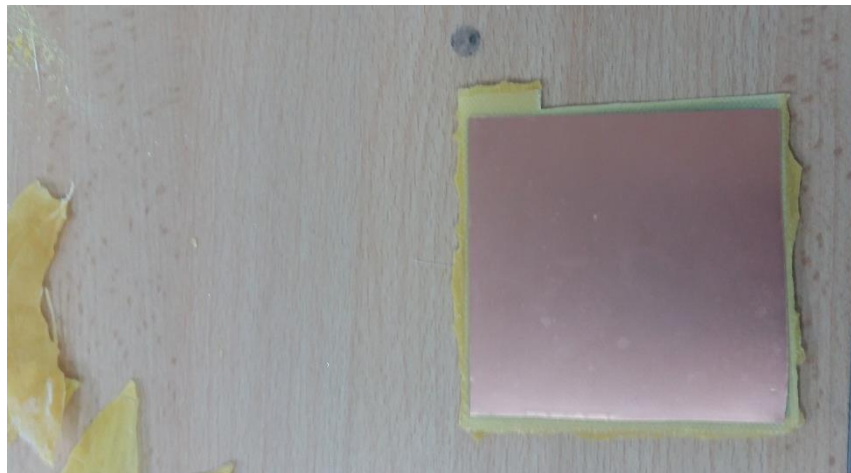
Figura 43. Suavizando los bordes de la PCB.
