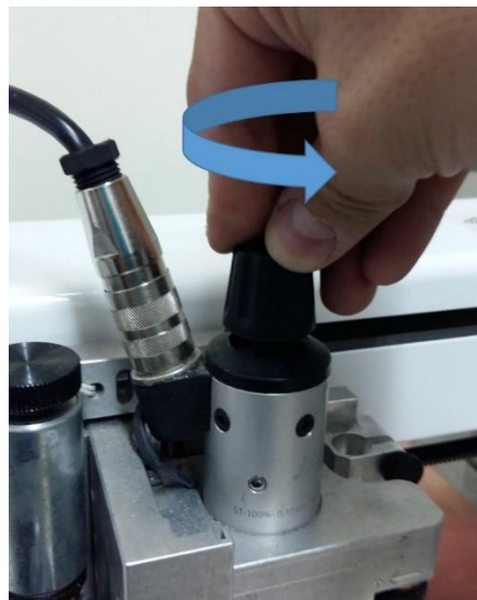
Figura 52. Giro del seguro de herramienta.
