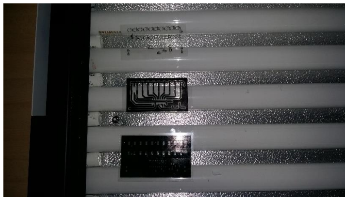
Figura 15. Ubicar el arte impreso en la insoladora.
