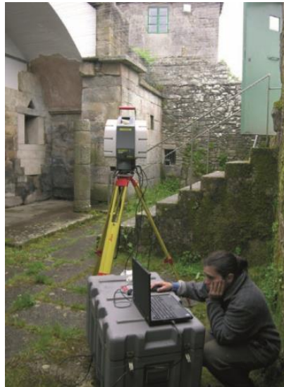
Figura 1. Instalación en campo del escáner 3D.
