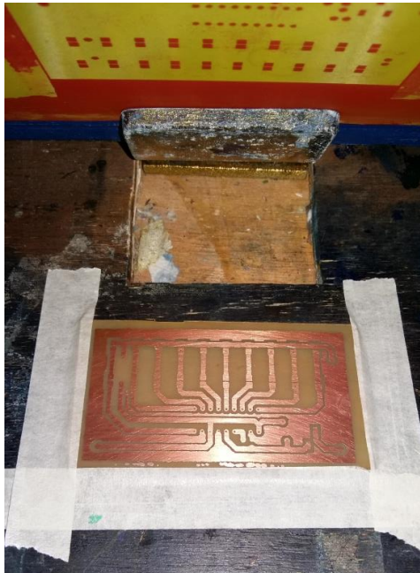
Figura 38. Baquela ajustada en la prensa.
