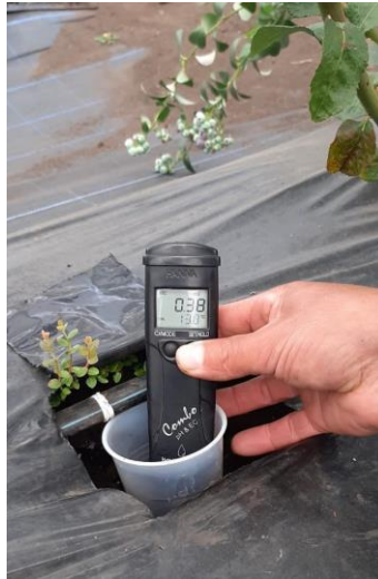
Figura 20, Verificación goteros en campo PH y CE, fuente MEDELLIN 2020
