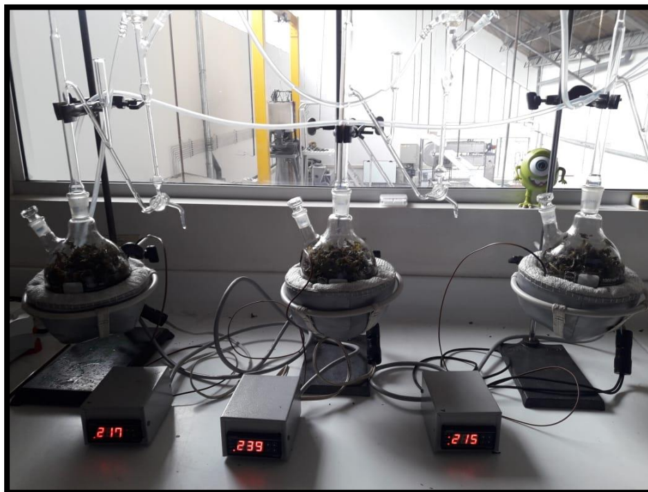
Figura 04. Montaje de destilación con 3 repeticiones con material en fresco (Duquino,2019)
