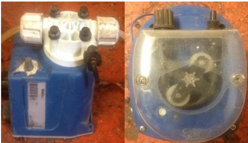
Fig. 22. Bombas Dosificadoras estado actual 2019, Fuente Propia
