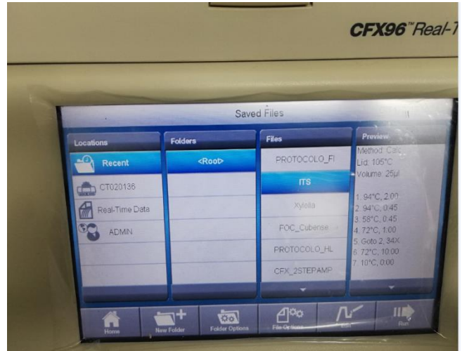
Programa Seleccionado para la PCR en hongos, se muestran los tiempos y temperaturas de cada ciclo. Fuente: Autor, 2019
