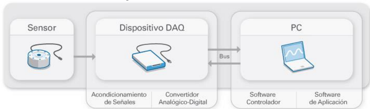
Figura 11. Partes de un sistema DAQ.
