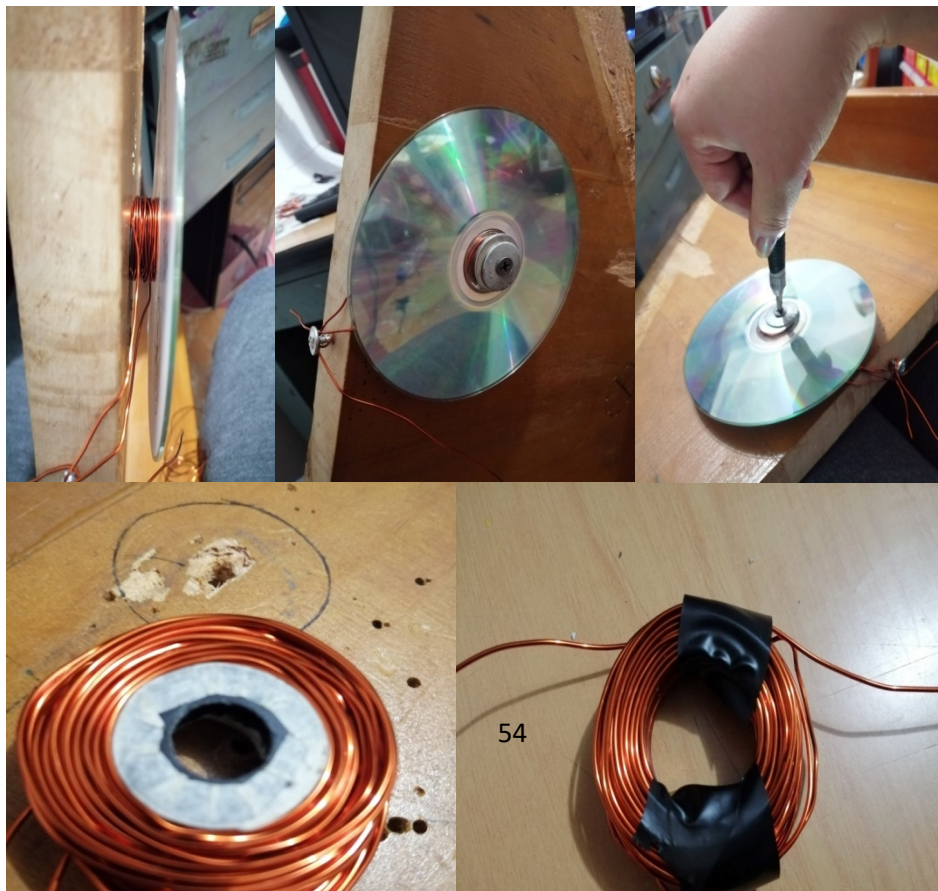
Figura . Procedimiento de la fabricación de las bobinas
