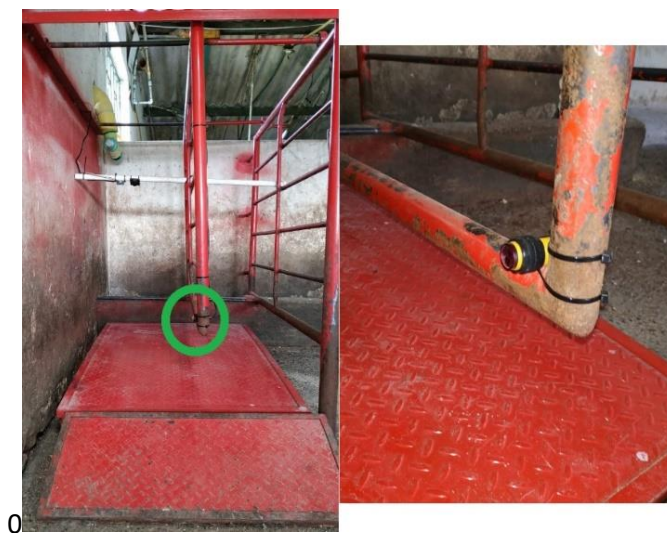
Figura 29. Dispositivo físico sensor de entrada. Elaboración propia.
