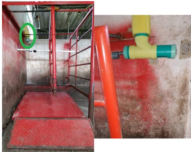
Figura 28. Dispositivo físico dispensador de alimento. Elaboración propia.
