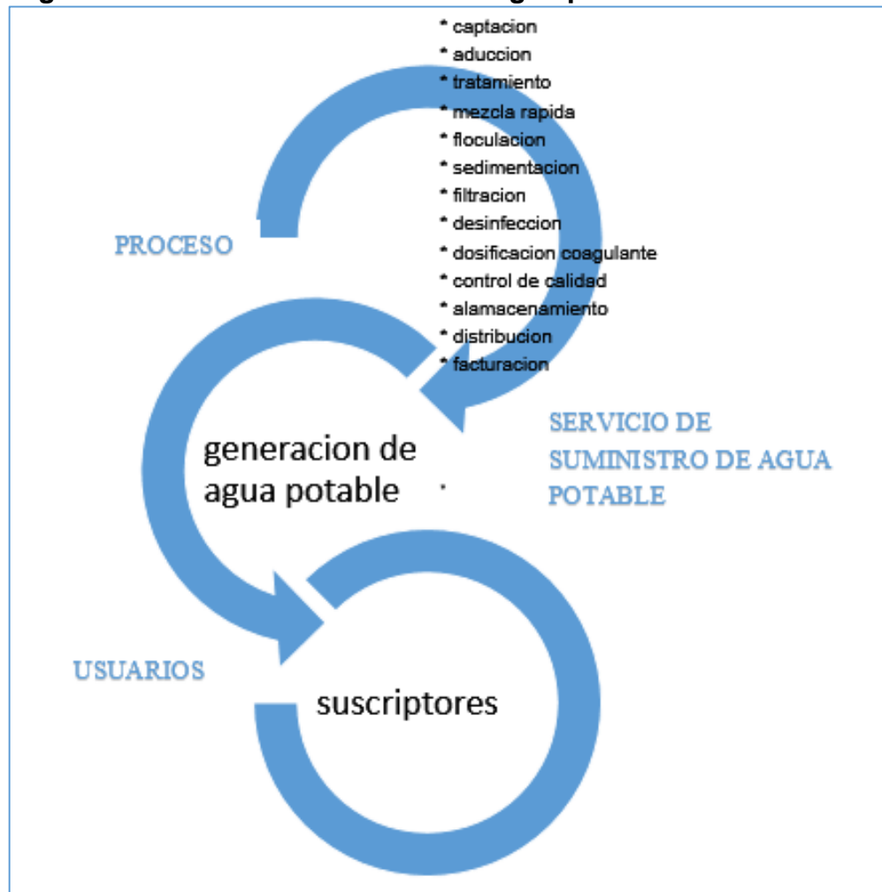
Figura 8. Proceso de suministro de agua potable
