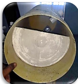
Imagen b. Pantalla pegada en la parte inferior del reactor anaerobio, Autoras.
