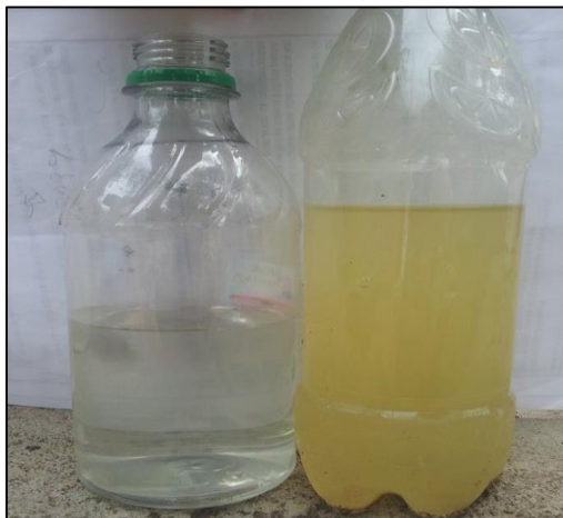
Figura 29: Agua tratada por el filtro lento en arena (izq.) y agua tratada por la laguna de maduración (der).
