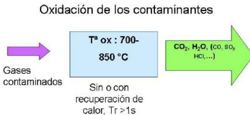
Ilustración 16. Principio de funcionamiento.
