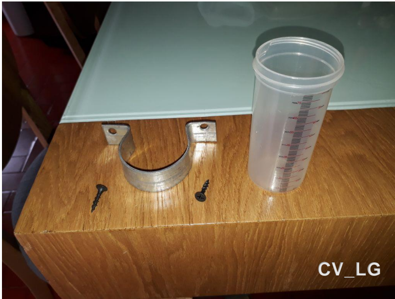
Abrazaderas de metal y tornillos para asegurar el pluviómetro
