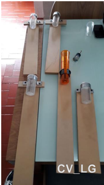
Ensamble de las piezas y pruebas de ajuste para 4 pluviómetros caseros y uno comercial
