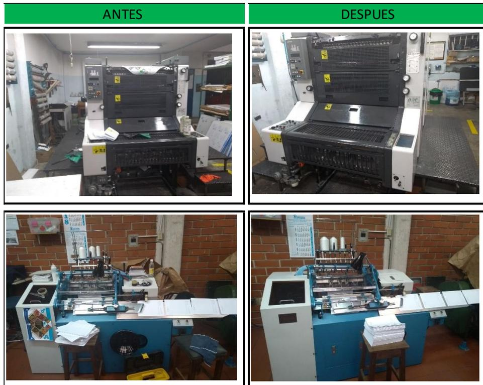
Como se puede ver en la ilustración anterior No. 31 con la implementación de orden en cada una de las maquinas se ubican los elementos necesarios para su funcionamiento en un lugar cercano y se retiran los innecesarios.
