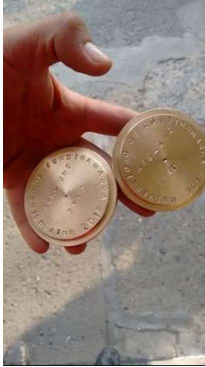
Fotografía 12 Formaletas y Placas utilizadas en la monumentación de los puntos
